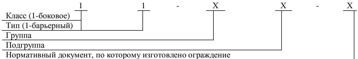
Класс удерживающего бокового ограждения для автомобилей - обозначают цифрой 1
