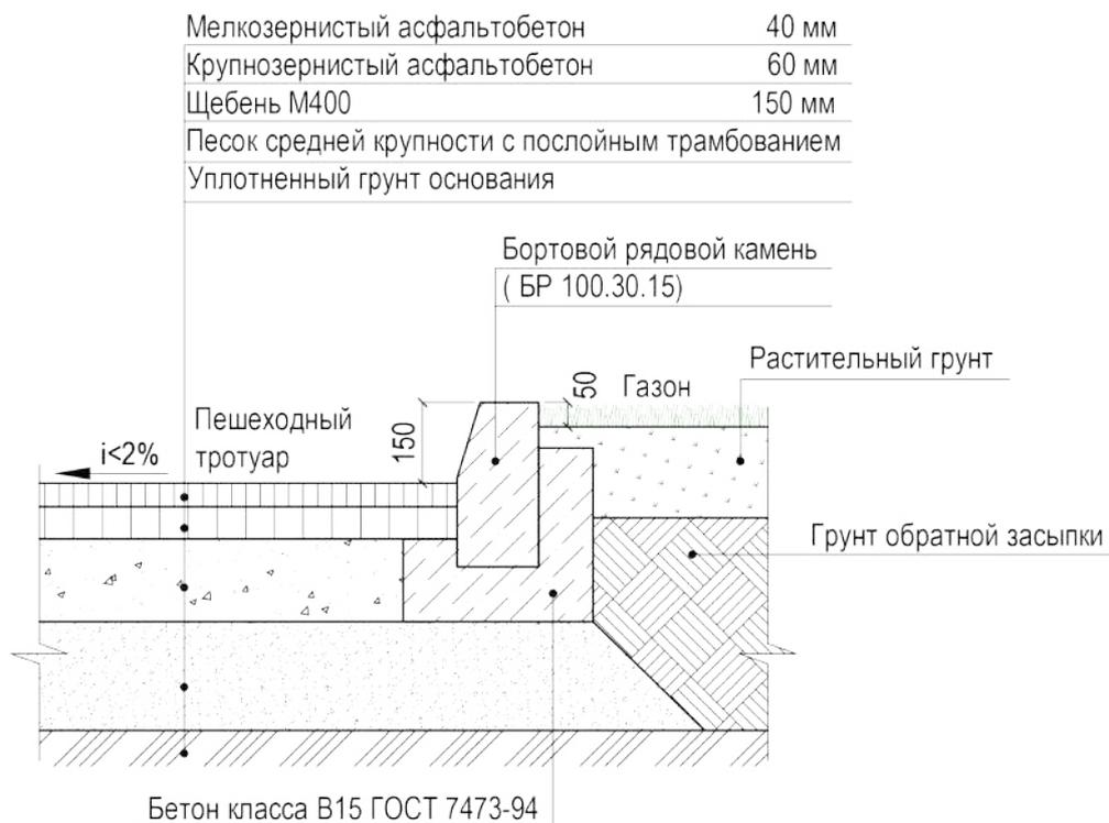
3.13.2 Узел установки бортового камня примыкания к газону
