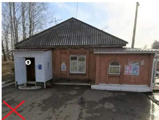
Вынос тамбура за пределы основного объёма здания, использование в качестве материала наружной отделки металосайдинга, информационная табличка с синим фоном, который не допускается для использования, размещение (расклейка) информационных материалов на фасаде.
