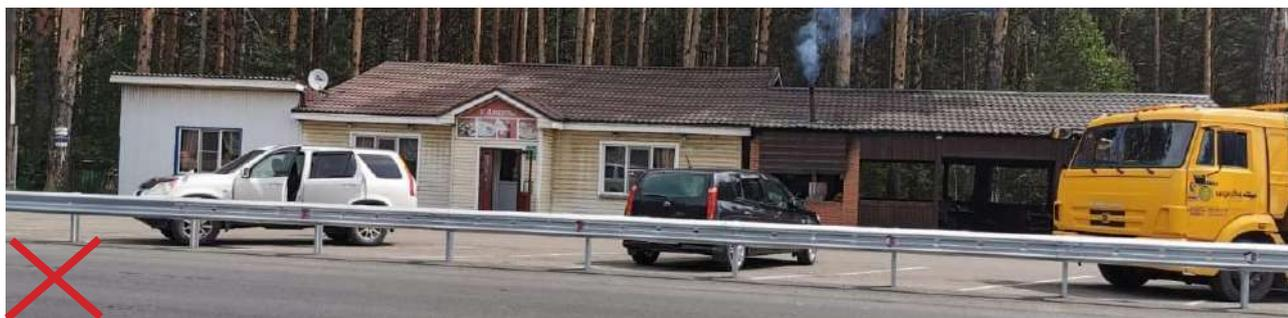
Недопустимо на одном объекте применять более двух типов отделочных материалов стен (штукатурка, кирпич, металлический сайдинг, деревянный брус), применять металлический профиль для обшивки фасадов здания.
