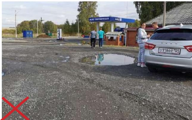
Недопустимо использовать парковку без твердого покрытия, разметки, отвода ливневых вод, пешеходных дорожек.
