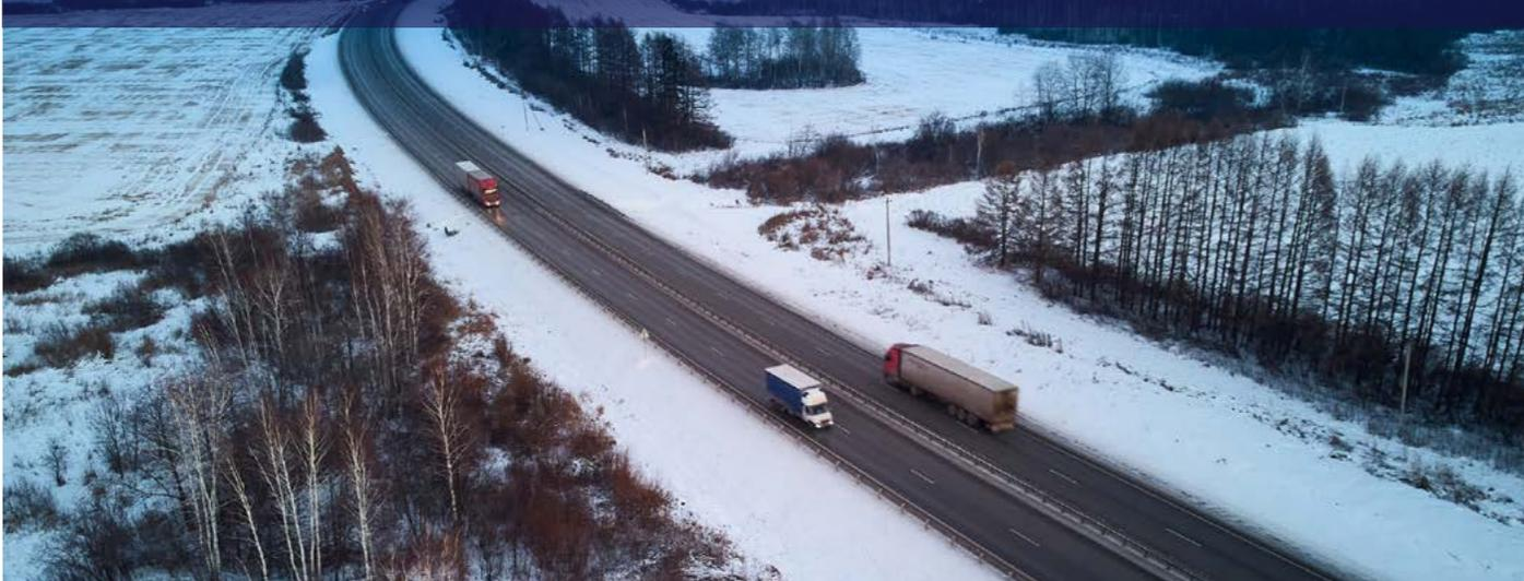
Отрезок трассы **расширили с 2 до 4 полос** движения, устроили барьерное ограждение. На участке также досрочно выполнен капитальный ремонт мостов через реки Юрмыч и Сугат. Для обеспечения маятниковой миграции населения и доступности подъезда к населенным пунктам на трассе были устроены **4 разворотные петли**.
