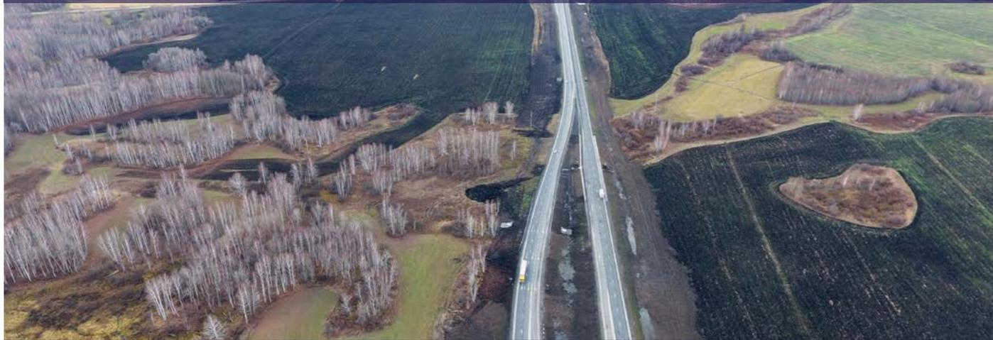
Участок длиной **19 км** возле Камышлова **стал 4-полосным**. Пропускная способность увеличена более чем в 3 раза: **с 6 до 19 тыс. автомобилей в сутки**. Разделение транспортных потоков барьерным ограждением поможет водителям **избежать лобовых столкновений**. Федеральная трасса **Р-351** Екатеринбург – Тюмень соединяет столицы двух субъектов Российской Федерации и входит в состав европейского транспортного маршрута **Е22**.
