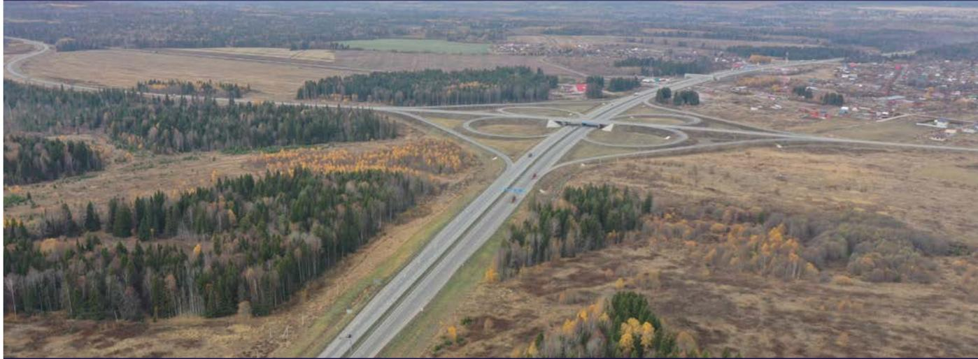
**9-километровый** участок переведен в категорию **ИБ** и имеет **4 полосы** движения с разделением встречных потоков. Строительство путепровода над региональной дорогой **Усть-Абакан – Черногорск** взамен кольцевых развязок позволило разделить транспортные потоки с федеральной трассой и обеспечить безопасный проезд в направлении этих населенных пунктов.
