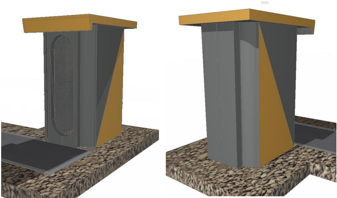
Рисунок 43 – Туалет, выполненный из железобетонных конструкций
