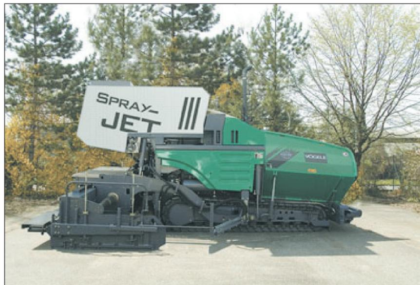
т, распадается, и водяные пары в процессе уплотнения катками выходят на поверхность, а модифицированное битумно-латексное вяжущее в идеальном случае должно подняться на 1/2-2/3 толщины слоя износа. В этом случае образуется не только надежная гидроизоляционная мембрана, но и прочная связь между основанием и слоем нового покрытия.
